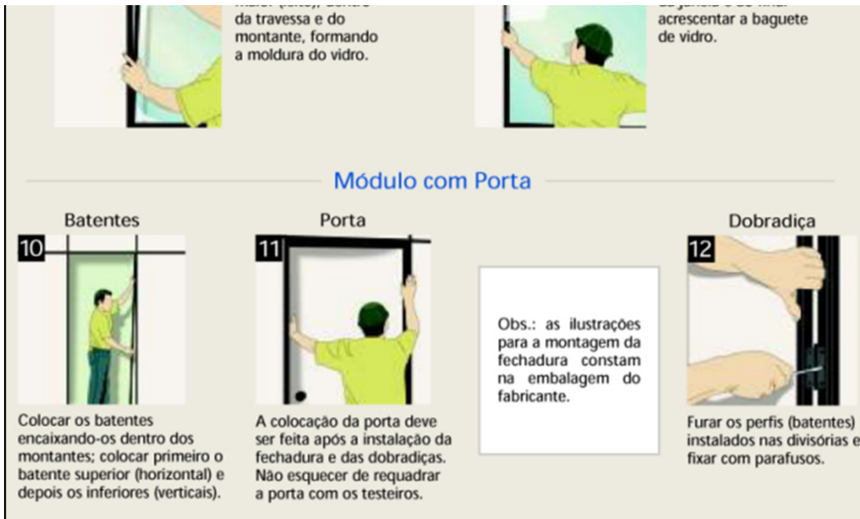
Figura 1 – Procedimento de montagem das divisórias (painel cego, módulo com vidro e módulo com porta)
